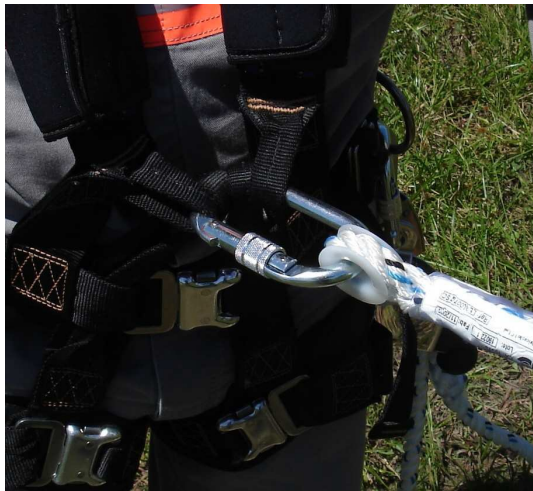
Figura 34 – Instalação do trava-quadras no cinto paraquedista
