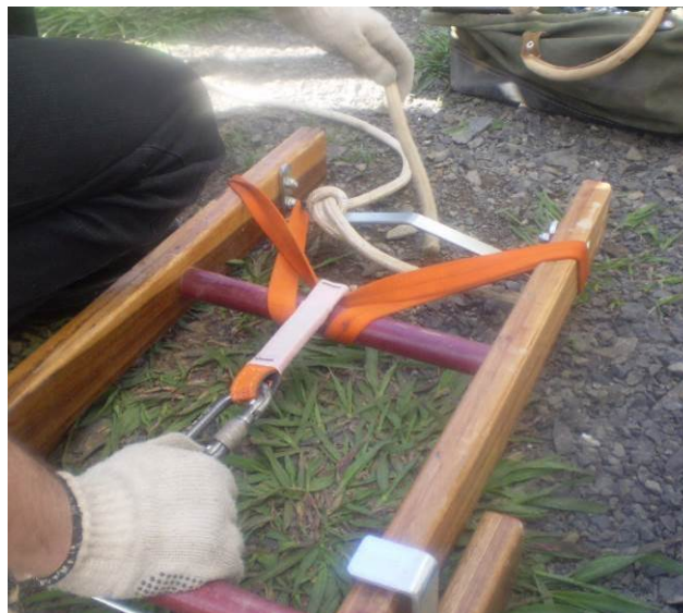
Figura 12 – Instalação do ponto de ancoragem
