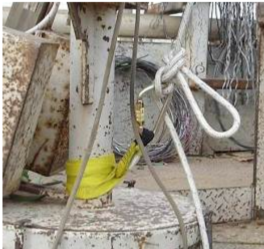
Figura 11 – Ponto de ancoragem
