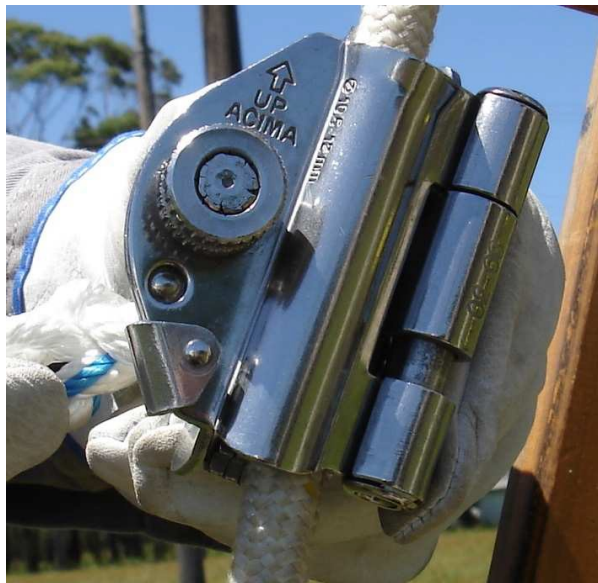
Figura 35 – Fechamento e travamento do trava-quadras
