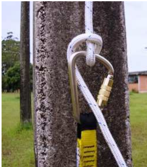
Figura 15 – Ajuste do nó de freio
